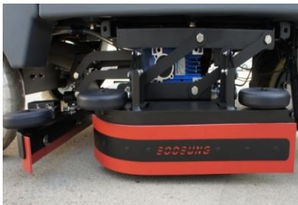
브러시데크와 스퀴지데크 일체형으로 청소능력 향상 및 AS 용이
